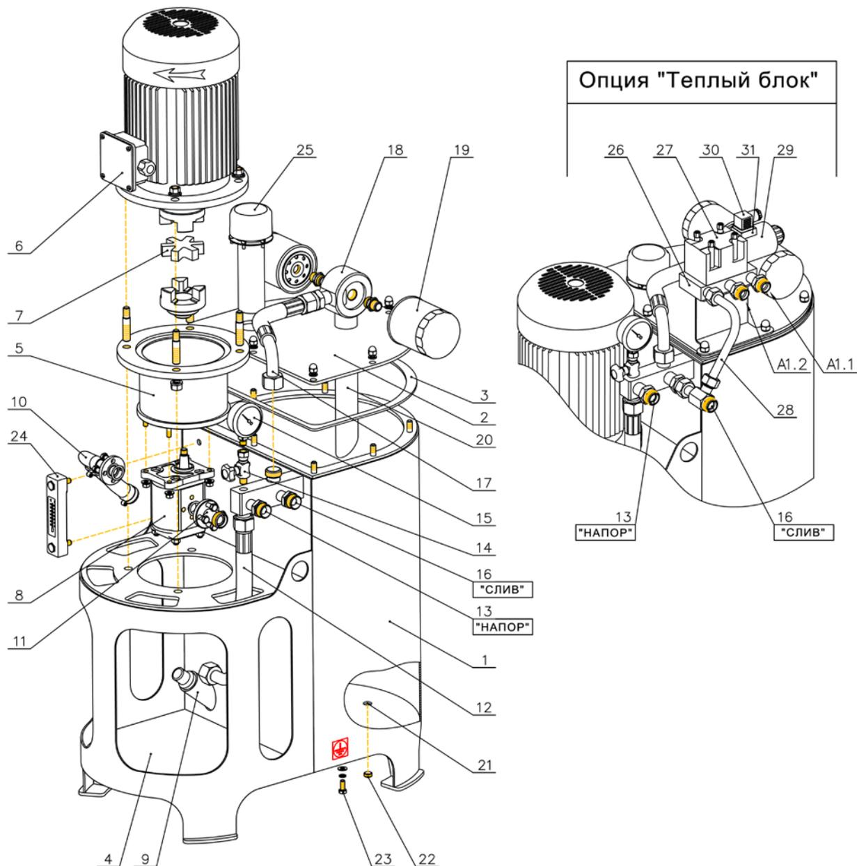
Рис. 12. Установка насосная.
