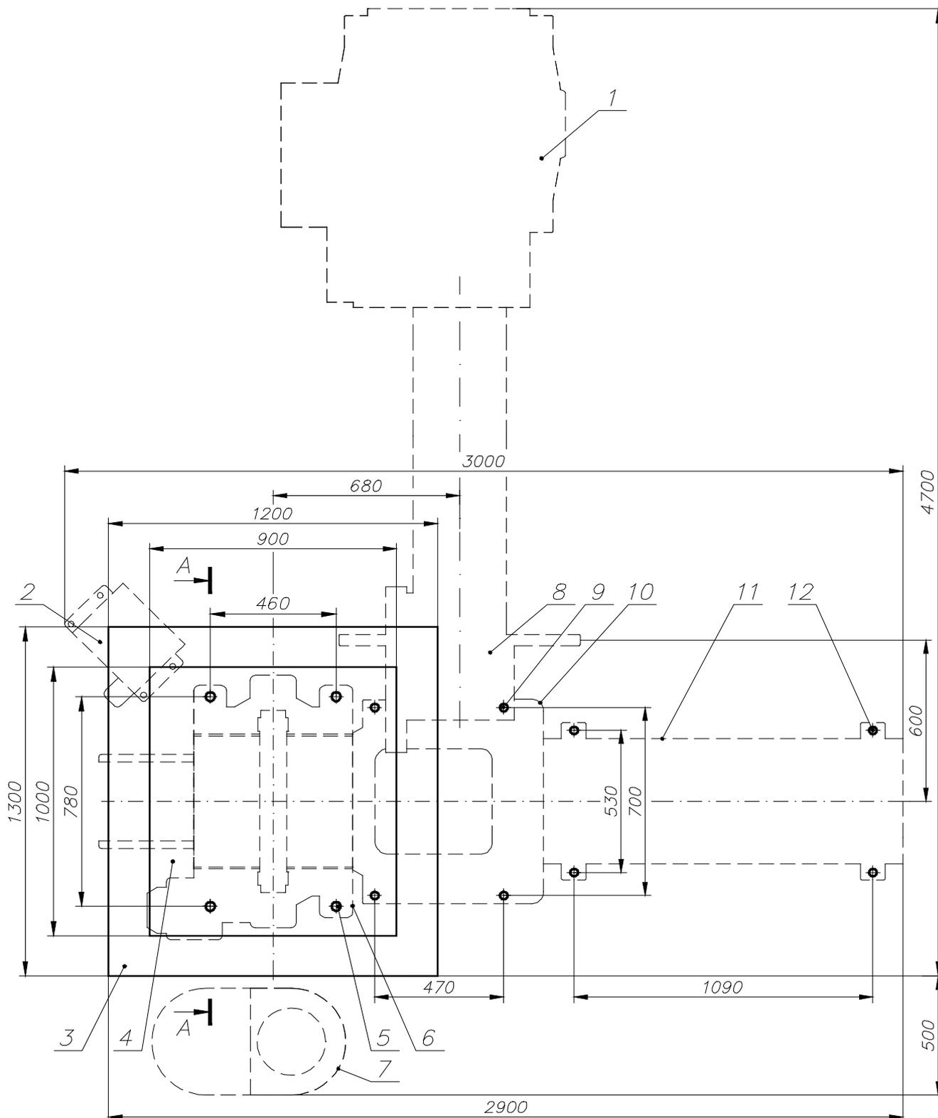
Рис. 19. План фундамента установки
