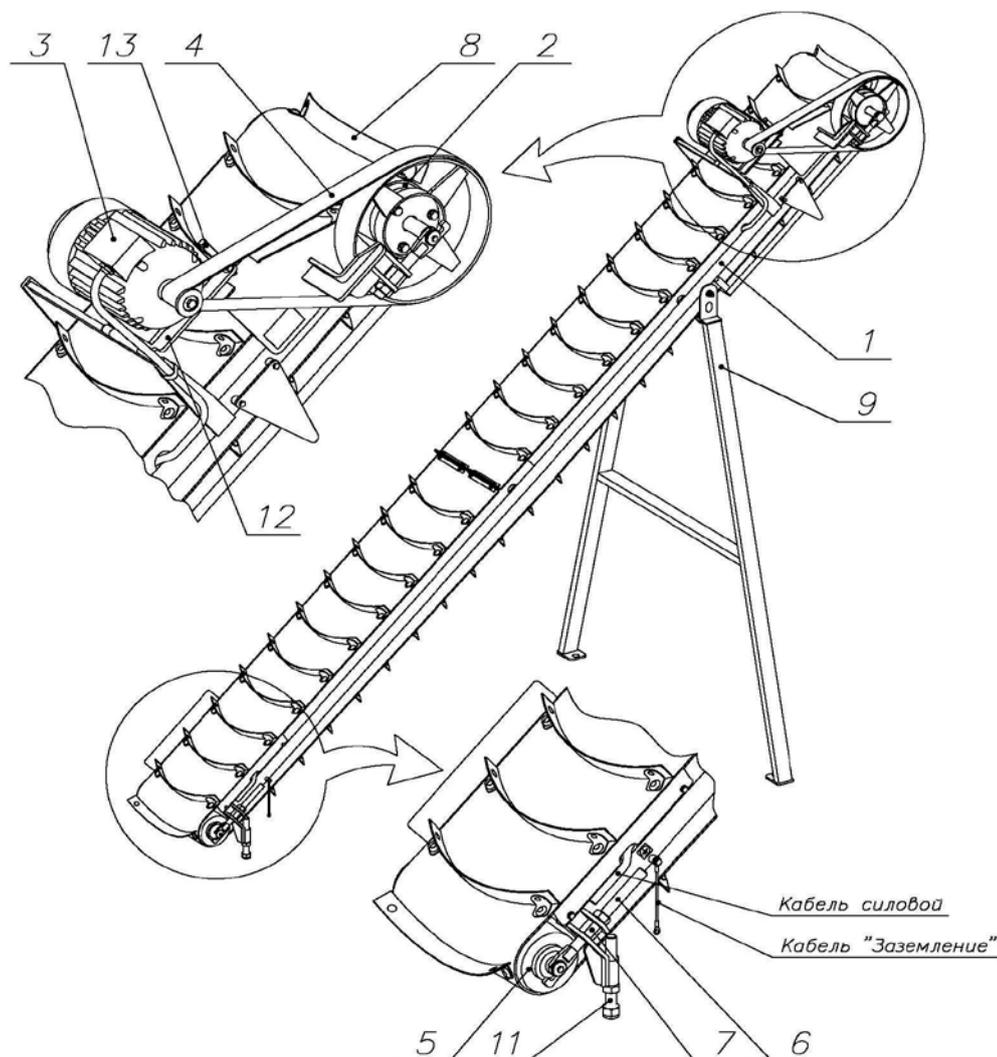
Рис. 7. Конвейер ленточный.
