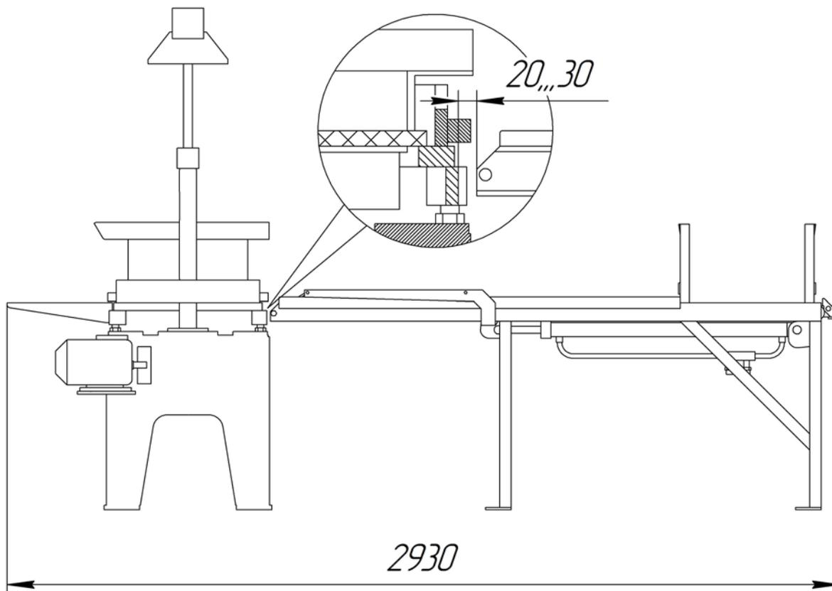
Рисунок 21. Монтаж модуля подачи поддонов к вибропрессу «КОНДОР».
