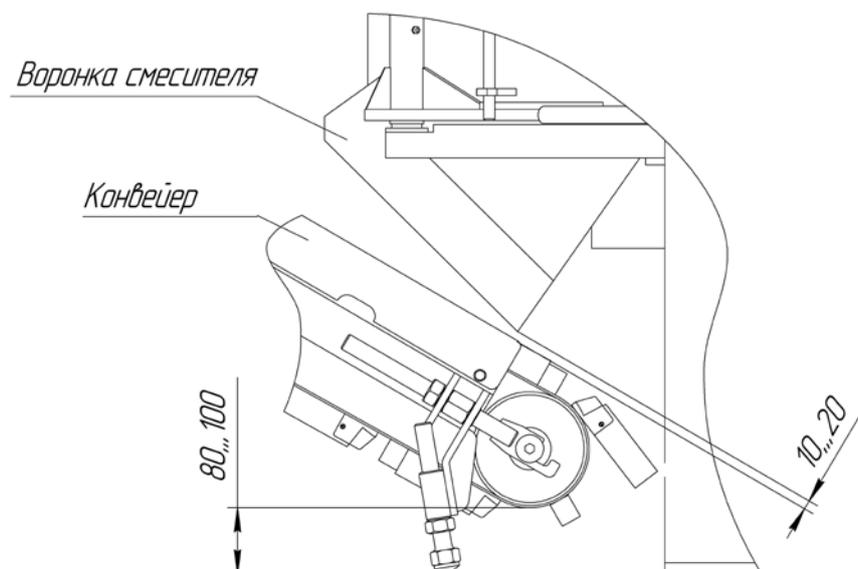
Рис. 8. Настройка зазора между смесителем и конвейером.
