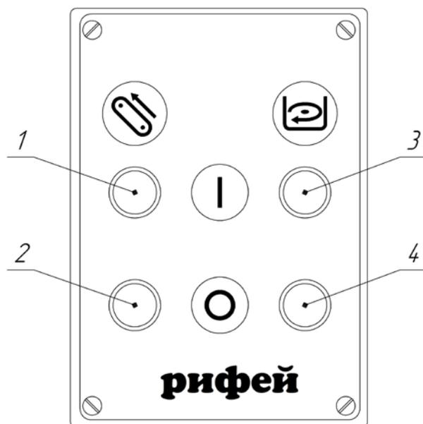
Рис. 5. Пульт управления смесителем и конвейером
