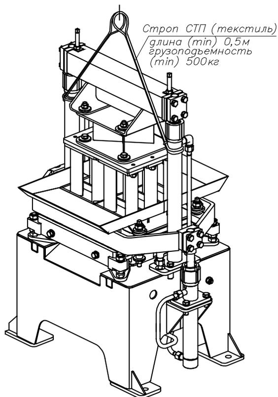
Рис. 22. Схема строповки вибропресса.
