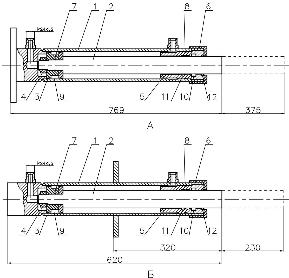
Рис. 15. Гидроцилиндры.
