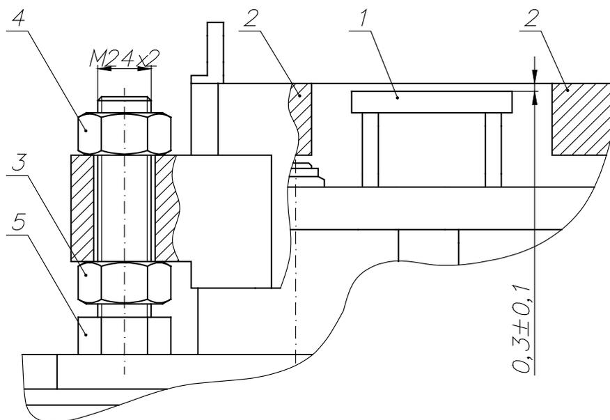
Рис. 20. Схема настройки зазора.
